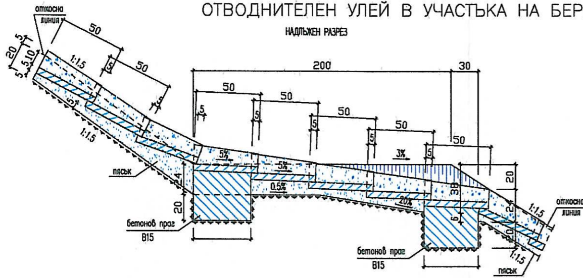
ОТВОДНИТЕЛЕН УЛЕЙ В УЧАСТЪКА НА БЕРМА ПОГЛЕД ОТ ГОРЕ
